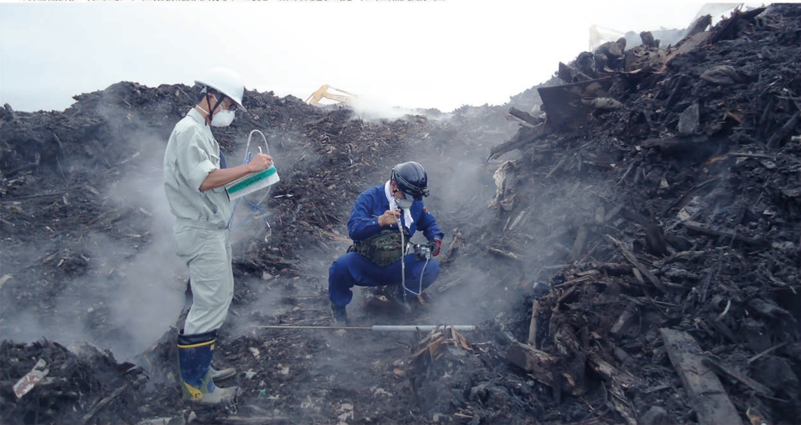
▼宮城県沿岸部一次仮置場にて（混合廃棄物層火災現場での温度と一酸化炭素濃度の測定 白い煙は無炎燃焼の煙）
