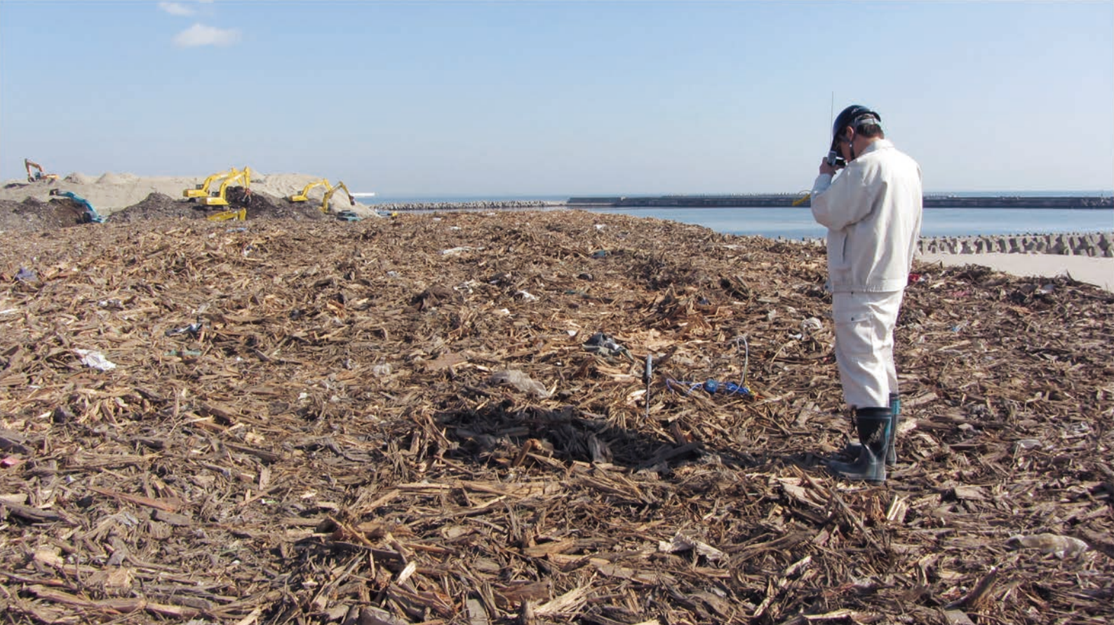
宮城県沿岸部一次仮置場にて（木くず仮置場での発熱部捜索）▲
