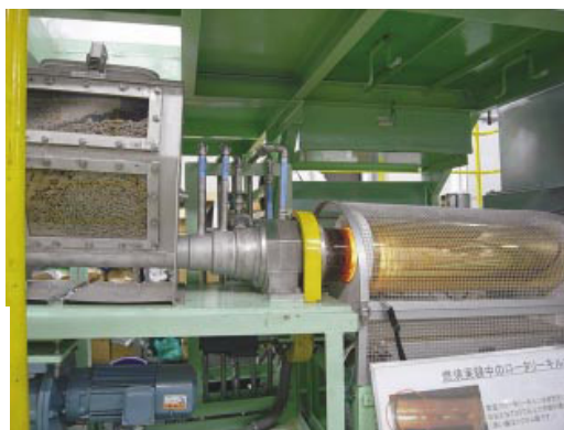
図 2.3 燃焼試験の様子 (試料投入ピットと一次燃焼炉 [ロータリーキルン])
