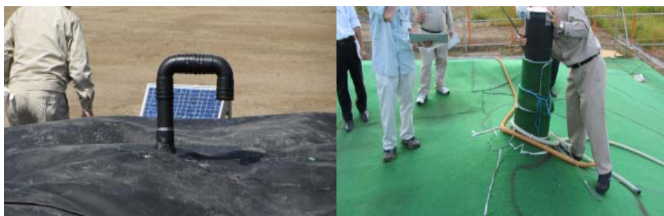
図 3.11 除染廃棄物の仮置場巡回による火災危険度診断や仮置方法の技術提案
