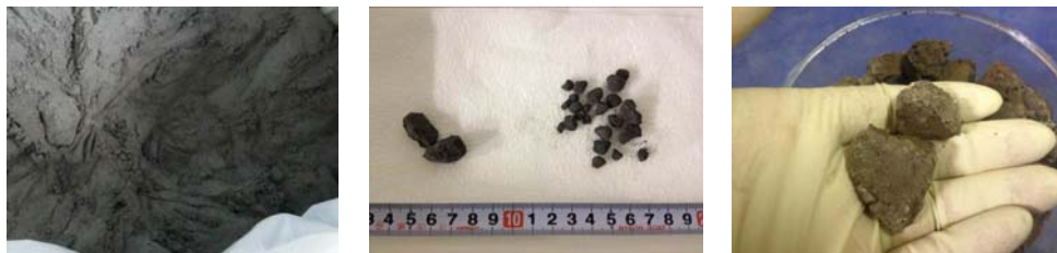
図 8.3 一般廃棄物焼却施設から排出された飛灰の例
