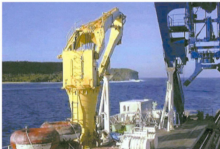
海洋研究船「みらい」搭載レーザーレーダー(中央の白いコンテナ)
