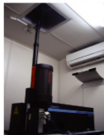
図1 国立環境研究所(茨城県つくば市)敷地内に設置されているライダー これと同じものがアジア各地に設置されている。
