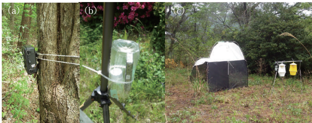
図1 生態系モニタリングに用いられる調査機材。(a) 国有林等に設置されたほ乳類調査のための赤外線自動撮影カメラ、(b) 小学校等に設置された鳥類・カエル類調査のためのICレコーダー、(c) マレーズトラップ（左）と衝突板トラップ（右）。衝突板トラップを支える三脚に、ICレコーダーも設置されています
