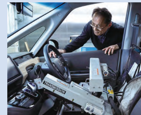
人に代わって車両を運転する自動運転ロボット
