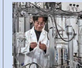
硝酸イオンの安定同位体分析に必要な前処理ライン (自作)
