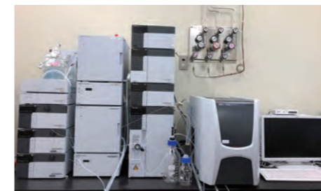
全有機炭素 (TOC) 検出器を備えた溶存有機物の分子量測定装置 * サイズ排除クロマトグラフ
