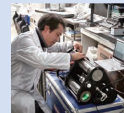
現場での光合成活性を定量評価できる FRR 型蛍光光度計
