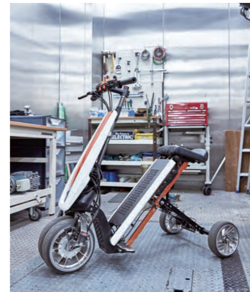
利用者と目的によって変形・連結する極小モビリティ(マルチパーパスモビリティ)
