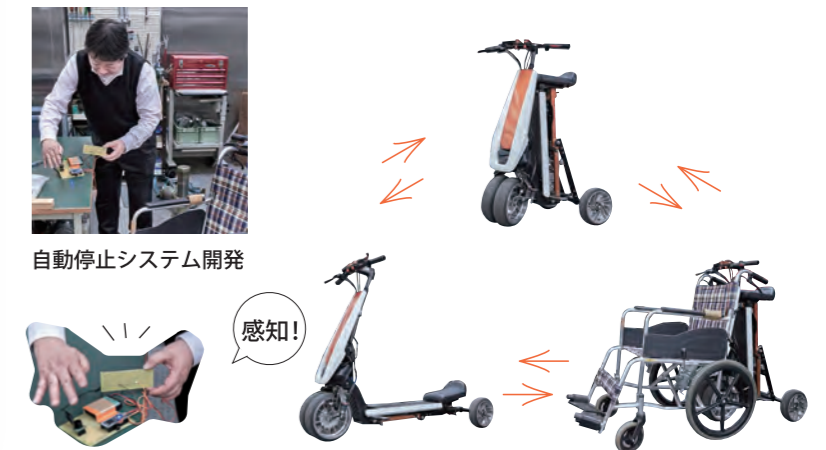
利用者と目的によって変形・連結する極小モビリティ(マルチパーパスモビリティ)
