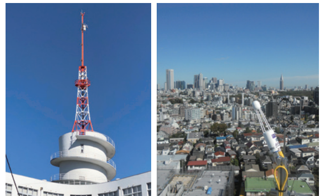
図2) 観測に使用しているタワーとCO 2 ・熱渦相関計測
