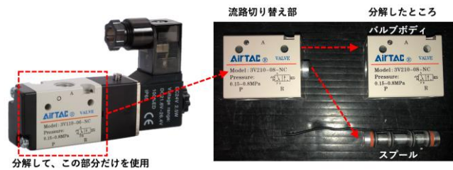
図 E-1. パイロット式電磁弁を分解し、流路切換に必要なバルブボディとスプールだけを使用する。
